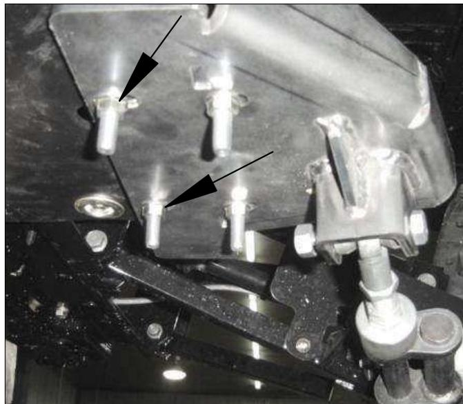
Fixer solidement sur la structure la pièce 03PA-260G.
