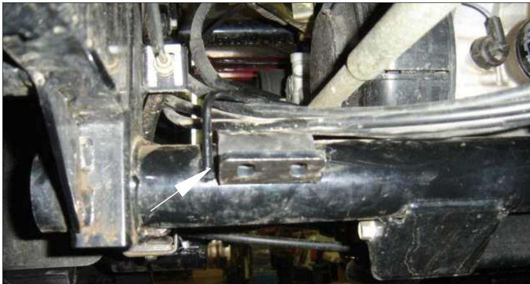
Du coté droit (coté passager), il faut passer la pièce 04PL-169 sous la tige en U (voir flèche). L'angle de 90° de la bracket vas vers l'arrière du véhicule.
