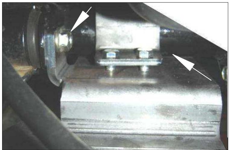
Pour installer la plaque 03PA-268G et D il faut enlever l'écrou du boulon qui tien le devant du ressort à lames (image de gauche). Le boulon s'introduit dans le trou du plis à 90° de la plaque.
