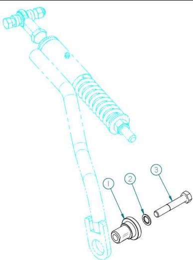
Retirez la vis et les douilles de la rotule à l'extrémité de la barre puis fixez la barre stabilisatrice à la plaque adaptation en prenant soin de garder les douilles entre la rotule et le support de la barre. Si votre support comprend 3 trous de positionnement, utilisez le trou du centre.
