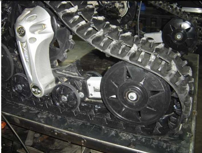
4. Enlever les 4 boulons à 6 pans creux fraisés (5/16") accessibles à l'avant du bras. Ceux-ci se retrouvent dans les 4 trous non-débouchants.
