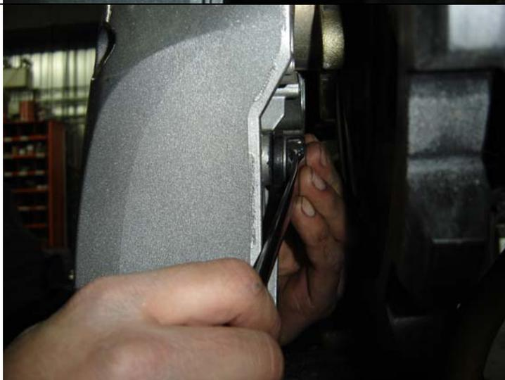
6. b) Dévisser l'extrémité du câble du support d'aluminium.
