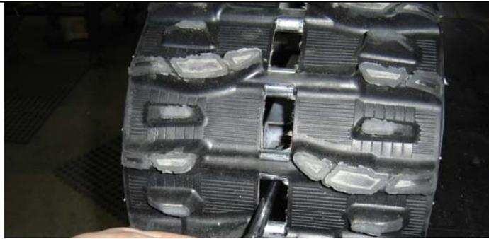
2. Dévisser le boulon sur le dessus de la plaque du tensionneur.
