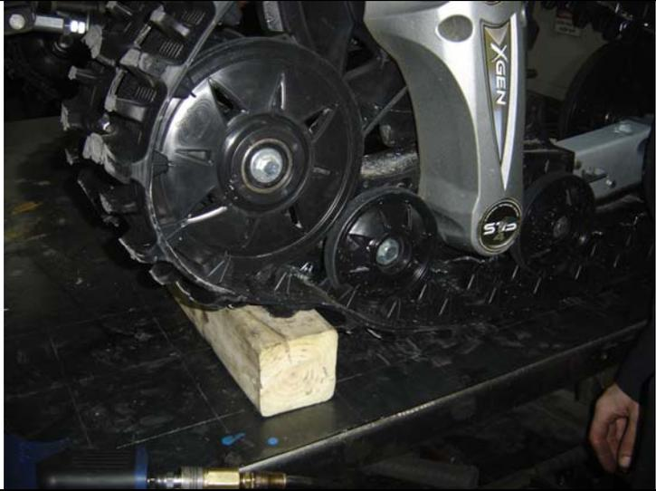
9. Fixer l'extrémité à deux trous sur le support d'aluminium. Utiliser le trou montré sur la photo.
