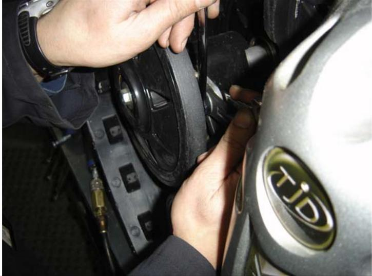
7. a) Installer l'extrémité avec un trou du nouveau câble sur le bras. Utiliser un enduit de blocage de filets (Loctite).
